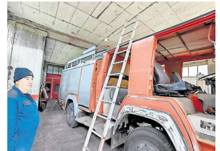
Die salzige Luft hinterließ Spuren: Ein Mechaniker auf Samos reparierte die Karosserie, Elektronik, Türen und Rollos. Foto: privat
