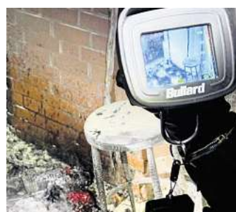
Nach dem Löschen: Kontrolle der Einsatzstelle mit der Wärmebild-Kamera.
