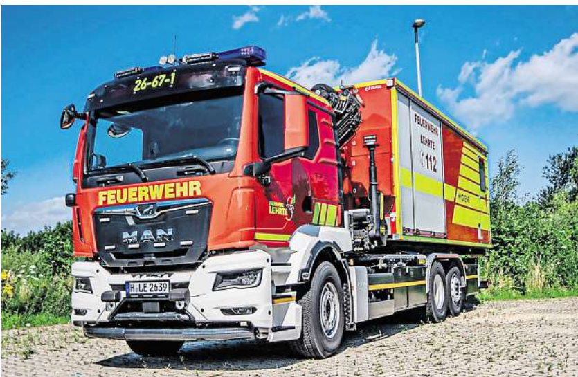
Flexibel: Mit dem neuen Wechsella- der können Con- tainer - wie hier der Hygienecon- tainer - an den Einsatzort ge- bracht werden. Foto: Stadtfeuerwehr Lehrte
