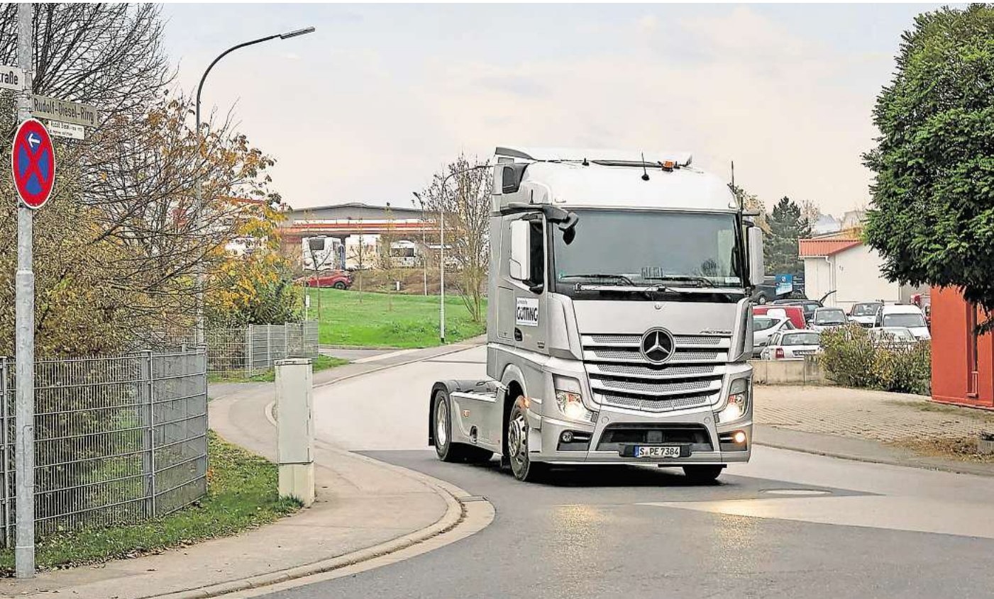
Mit der Technologie der Götting KG unterwegs: Schwerlastler ohne Fahrer am Steuer.
