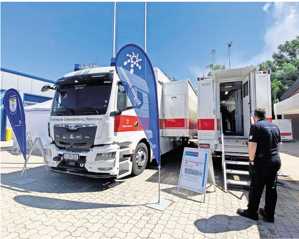
Die sogenannte Slide-Out-Technik: Der Einsatzwagen der TEL lässt sich auf beiden Seiten bis auf insgesamt acht Meter herausfahren. Foto: Katerina jarolim-vormeier
