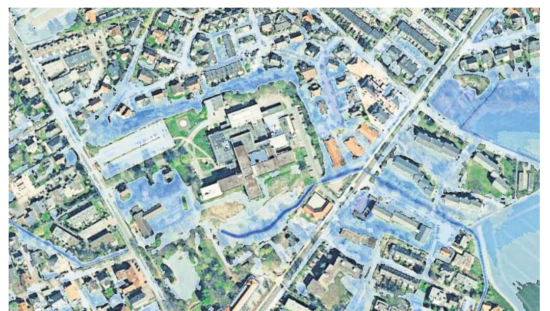
Hier drohen Überflutungen: Im Bereich des Krankenhauses (Bildmitte) und am Bach Wedel finden sich viele dunkelblaue Gefahrenbereiche.
