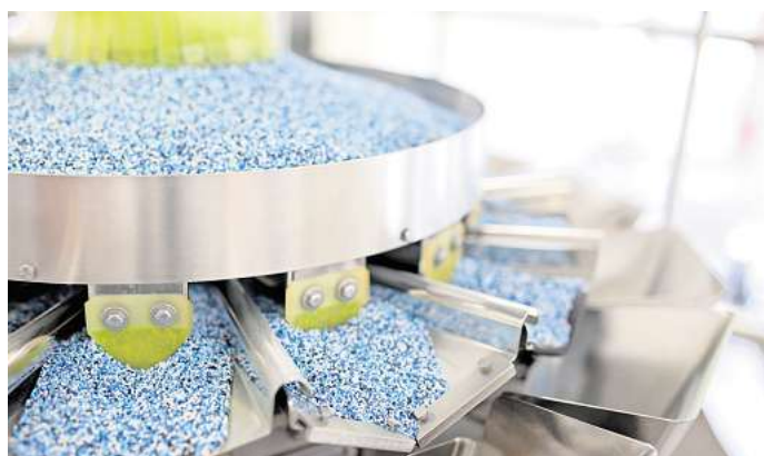
Automatisch: Diese Maschine füllt die Streusel ab.
