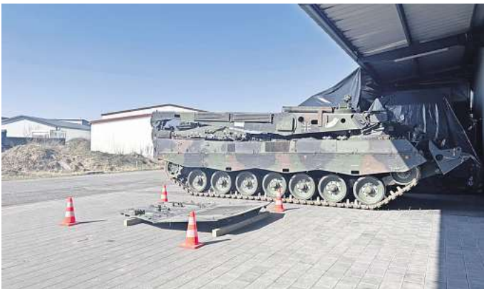
Der Abschleppwagen für Militärfahrzeuge: Mit dem Bergepanzer Büffel 3 können nicht mehr fahrtaugliche Panzer transportiert werden. Er wird für die Bundeswehrübung in Kleinburgwedel genutzt.
