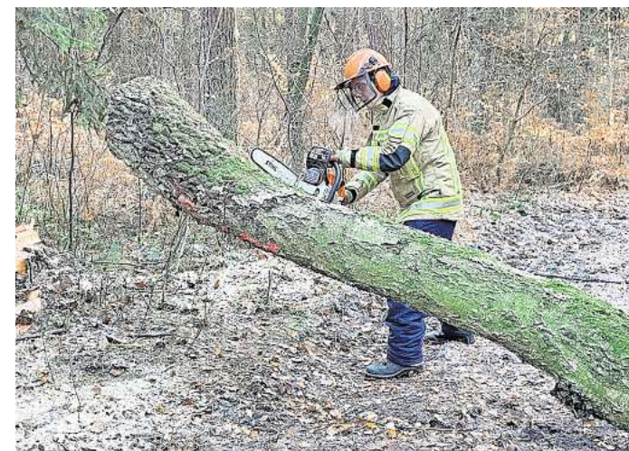
Beim Sägen von muss die Zug- und Druckseite beachtet werden.
