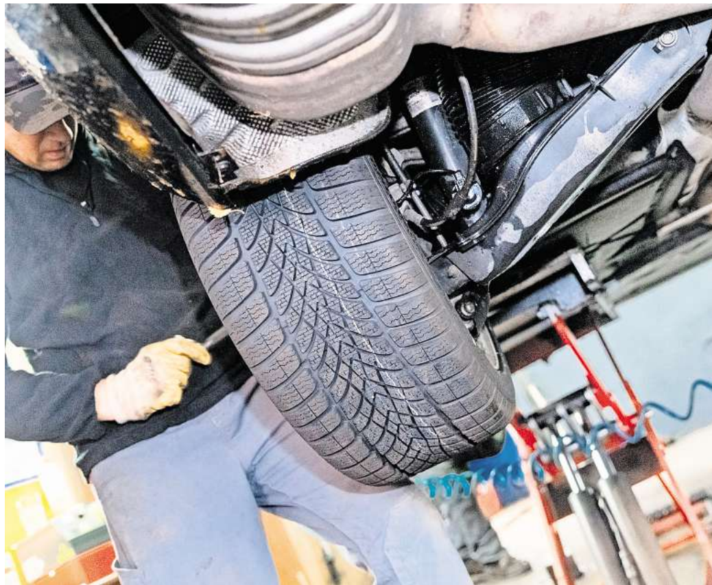
Winter- und Ganzjahresreifen haben meist laufrichtungsgebundene, pfeilförmige Profile, die Wasser und Schneematsch nach außen leiten und so für sicheren Bodenkontakt sorgen.
