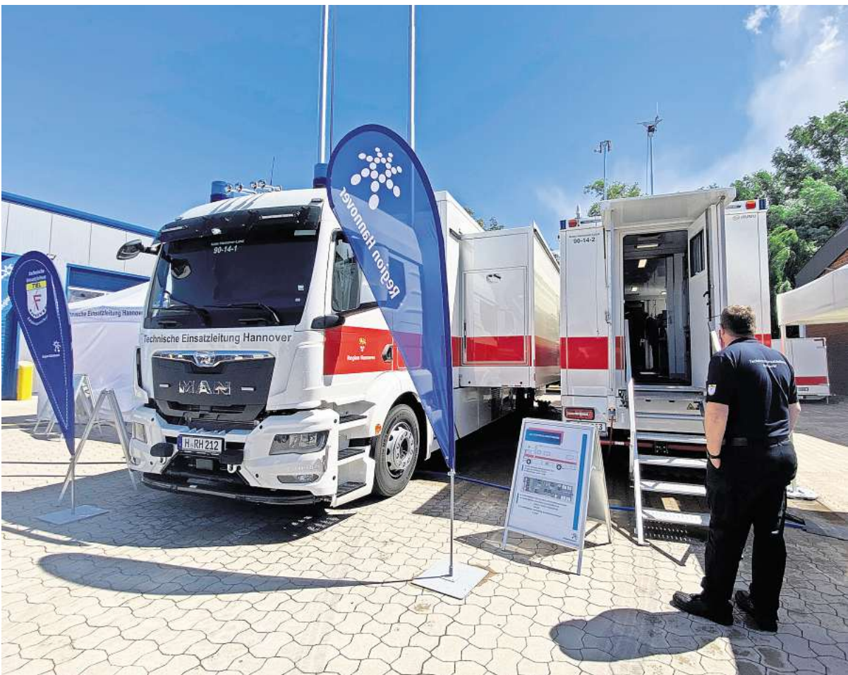
Die sogenannte Slide-Out-Technik: Der Einsatzwagen der TEL lässt sich auf beiden Seiten bis auf insgesamt acht Meter herausfahren. Foto: Katerina jarolim-vormeier
