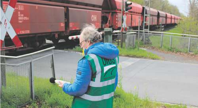
Arnim Goldbach misst den Lärmpegel des durchrauschenden Güterzugs am Bahnhof Otze.
