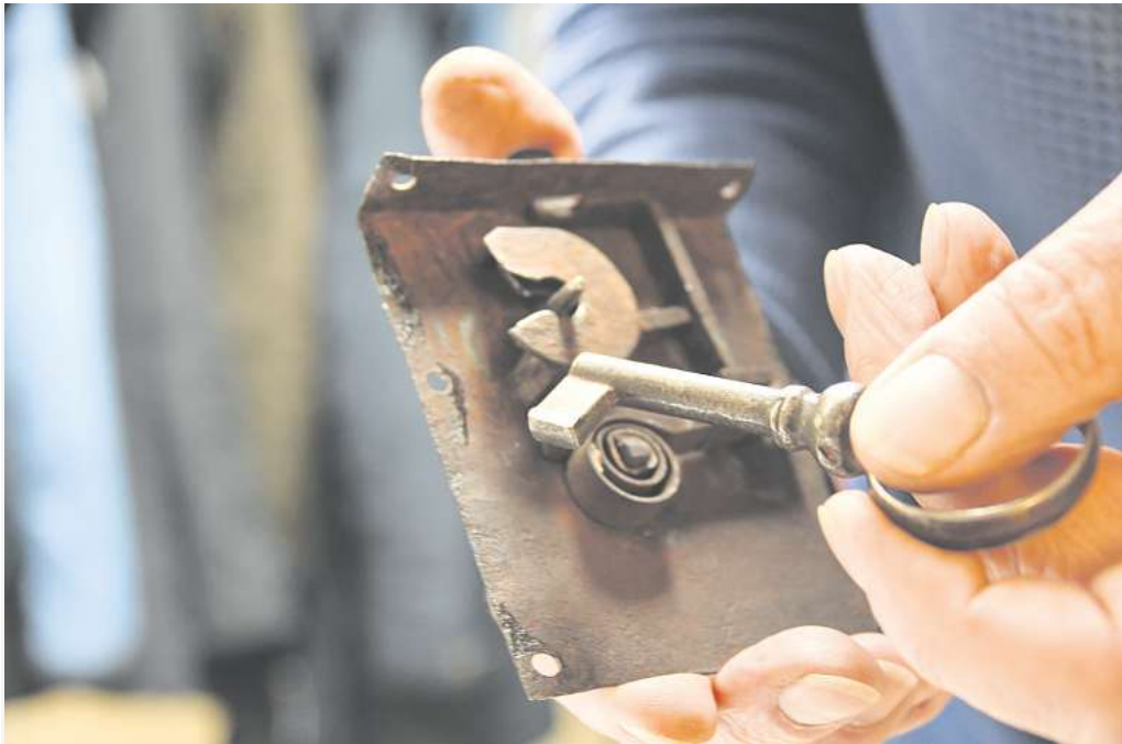
Das 200 Jahre alte, genietete Metallschloss funktioniert. Aber dem Schlüssel fehlt ein Schlitz im Bart. Deshalb funktioniert die Kombi nicht.
