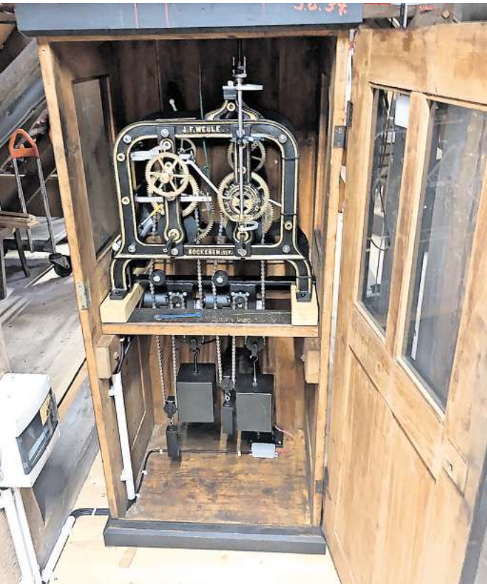
Wird nun elektrisch betrieben: So sieht das fast 100 Jahre alte Uhrwerk auf dem Spritzenhaus in Otze von innen aus. Foto: Patricia Oswald-Kipper
