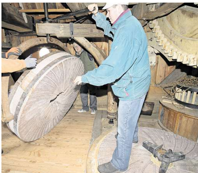
Unter Aufsicht von Kursleiter Rüdiger Hagen wird der tonnenschwere obere Mahlstein mithilfe des Steinkrans angehoben. Fotos: Wilfried Künstler
