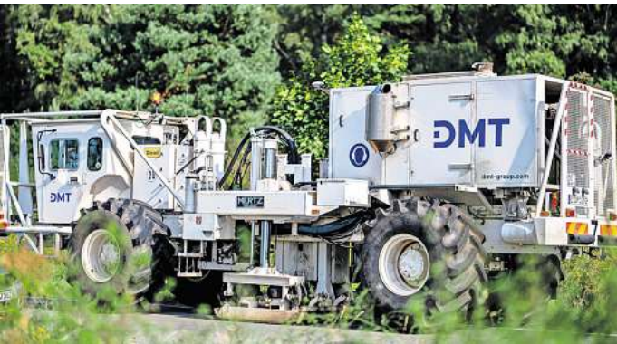
Untersuchen den Isernhagener Untergrund: die gut 20 Tonnen schweren Vibrotrucks des Ingenieursdienstleisters DMT.
