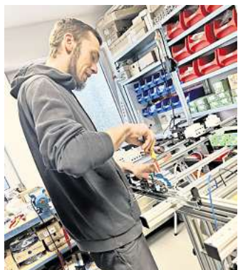
Versierter Mitarbeiter: Dominic Zapf baut in der Werkstatt eine neue Verteilung.
